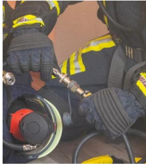
Anschluss an Mitteldruckleitung
